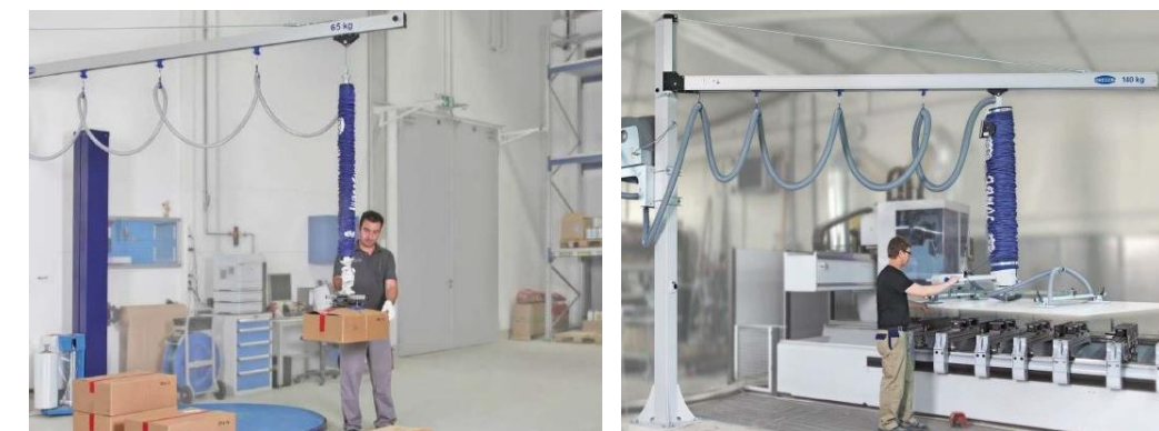
重量物の運搬や移動をアシストする シュマルツ『手動搬送システム』
